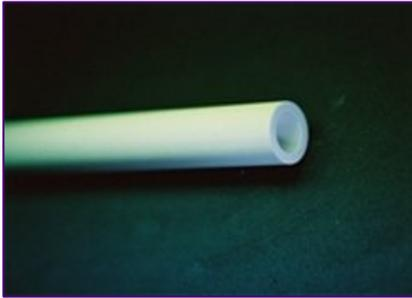
Керамика с повышенным содержанием оксида алюминия Al<sub>2</sub>O<sub>3</sub>, из которой изготавливаются защитные чехлы для термодпар, поставляется трёх классов и сортов:
