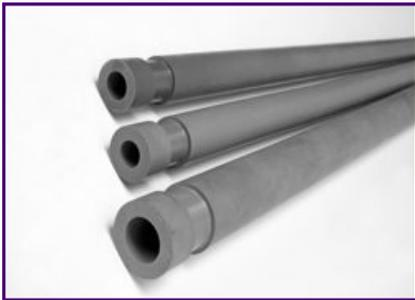
Керамика на основе нитрида кремния Si<sub>3</sub>N<sub>4</sub> имеет нулевую пористость и изготавливается в рамках процесса т.н. шликерного литья, который не позволяет добиться минимальных допусков по геометрии изделий, но позволяет получить абсолютно плотный материал.
