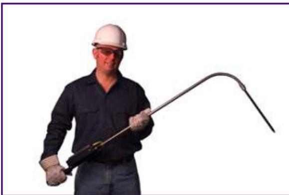
Термопреобразователи для расплавов металлов используются для замеров температуры в расплавах цветных металлов и в частности алюминия и меди. При этом замеры могут производиться как в течение нескольких секунд, так и продолжительное время непосредственно во время процесса плавки и литья. Замеры могут производиться в литейных желобах, плавильных (тигельных) печах, а
